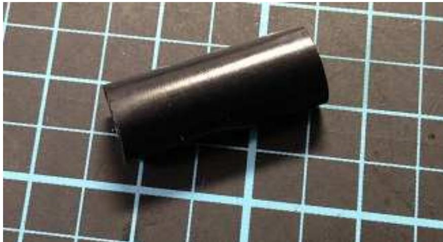
抵抗の付けた配線が隠れる様に熱収縮チューブを取り付け、ハンダゴテ等で収縮させます。
