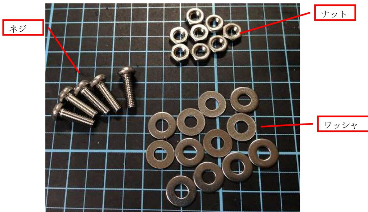
基板の表（部品が取り付けられてる面）からネジ、ワッシャ、基板、ナットの順で取り付けます。
